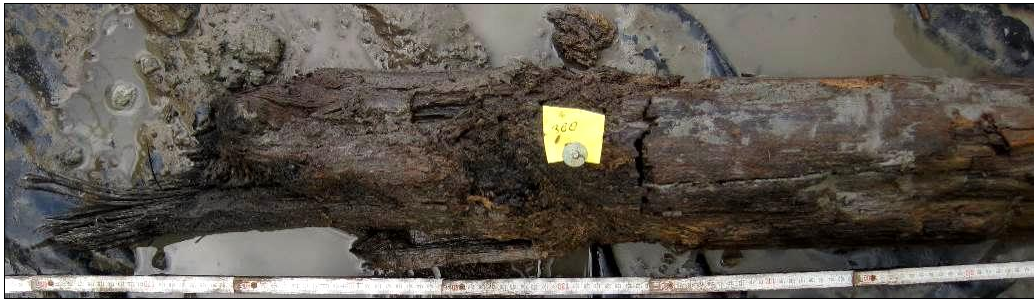
Figuur 44: Paal met rechthoekig gat van pen-en-gat verbinding (S388/V488) (©IDDS).
